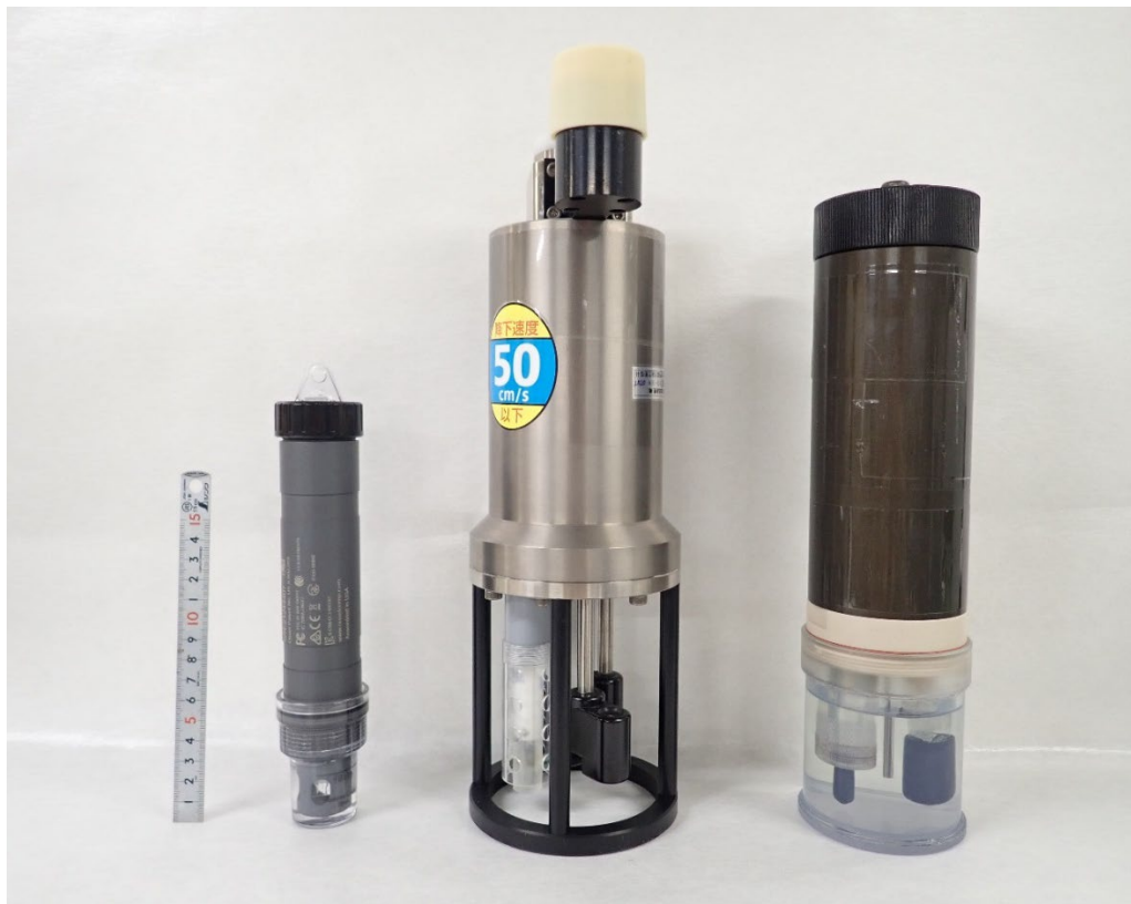
図 6.8-3 調査に用いる機種の候補としたセンサーの外観 (SPS-14 (写真右)、AAQ-RINKO (写真中央) および CO-MX2501 (写真左))
