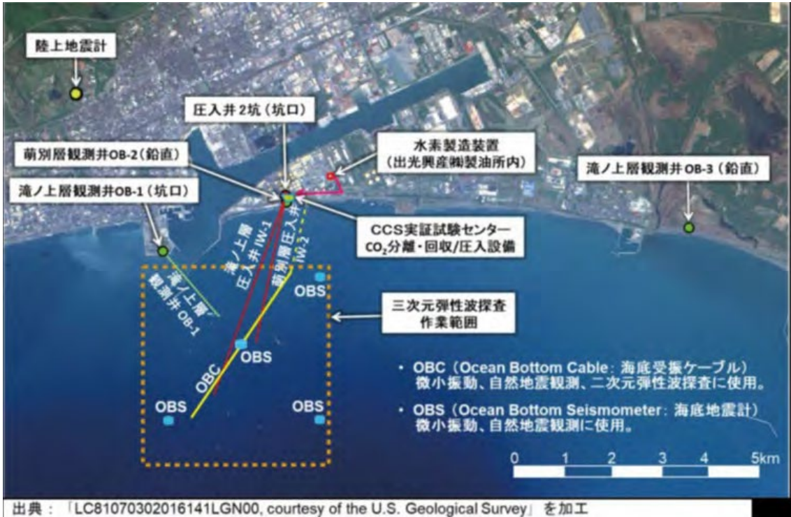
図 1.4-1 圧入井、観測井およびモニタリング設備の配置
