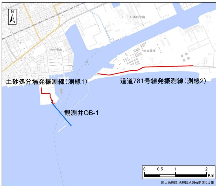
図 4.4-6 観測井 OB-1 坑跡および VSP 発振測線位置図
