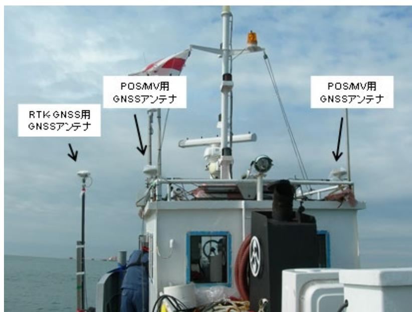
図 4.2-12 調査船に艦装した RTK-GNSS 用と POS/MV 用の GNSS アンテナ
