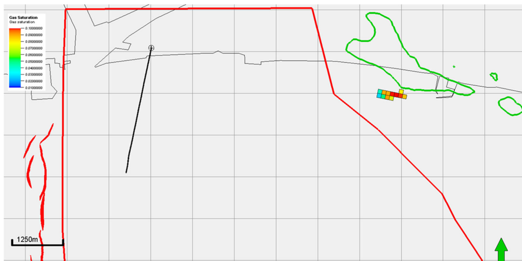
図 5.3-61 気相 CO 2 飽和率分布 (具現像 26 における累計圧入量 1,600 万 t-CO 2 圧入後の圧入停止 1,000 年後、下限値:0.01 上限値:0.1、k=8)
