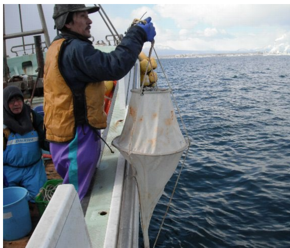
図 6.2-6 北原式定量ネットを用いた動物プランクトン採集 (イメージ)
