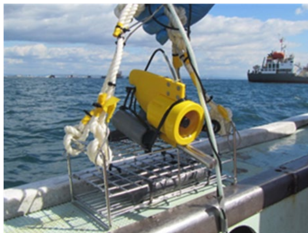
図 6.2-10 気泡監視のための水中カメラ
