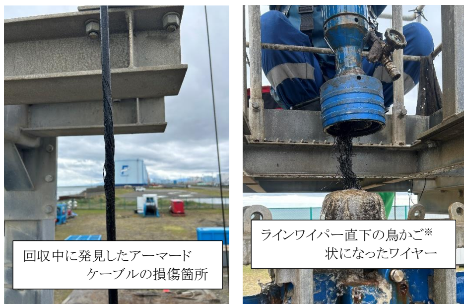
図 4.1-43 アーマードケーブルの損傷箇所とラインワイパー直下の鳥かご状のワイヤー
