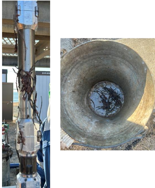
図 4.1-48 回収したケーブル素線
