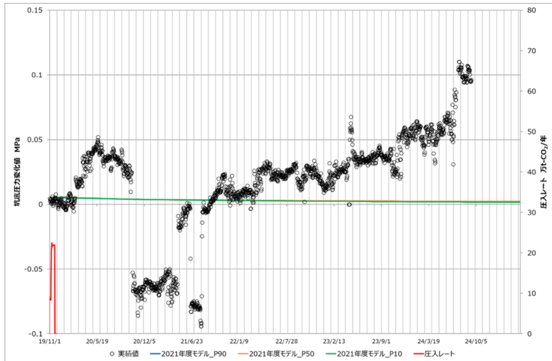
図 5.1-3 IW-2 の圧入レートと OB-2 の坑底圧力の予実績比較
